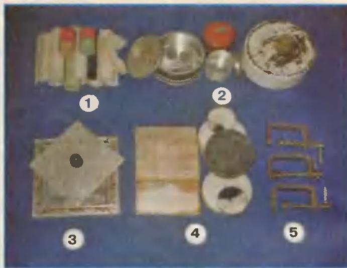
1 — исходный материал для плавки; 2 — круглые формы 135x65 мм и 70x40 мм с колпаками к ним, 3 — плоская форма с пресс-крышкой для изготовления плиток; 4 — готовые плитки 220x220x10 мм; 5 — струбины для опрессовки расплава
